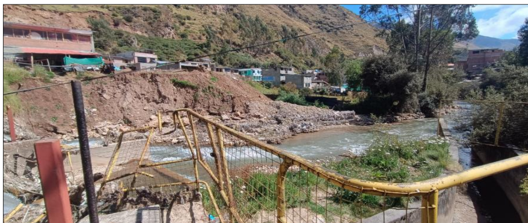
FOTOGRAFIA N°03: Panorámica de un sector del Río Huallaga con inestabilidad en las márgenes, mostrando erosión activa y daños en la infraestructura adyacente (barandas y terreno), con viviendas cercanas en riesgo.
